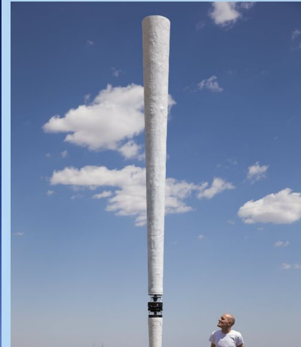
Вибратор Vortex Bladeless использующий явление аэроупругого резонанса
